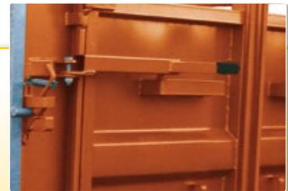
■ Possibilité de régler et verrouiller l'angle d'ouverture des portes arrière.
